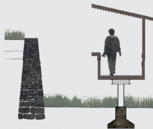
CORTE DETALLE PASARELA Y MURO INCA
